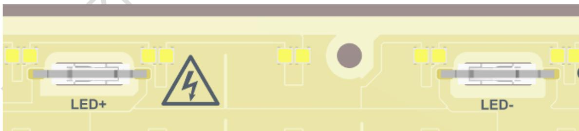
Abbildung 2: Anschluss " LED+ " & " LED- "
